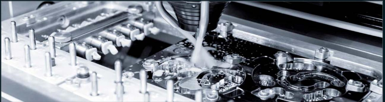
Combinación de las sujeciones 2-Blank-Plate y Raw-Abutment®/Bridge-Rod Holder M4, Glass Ceramics Holder M4, Combi-Holder Raw/Glass M4 o JawPositioner Support para procesar hasta 2 bloques de material (Ø 95 mm) y 10 Raw-Abutment®/Bridge-Rod o bloques de vitrocerámica
