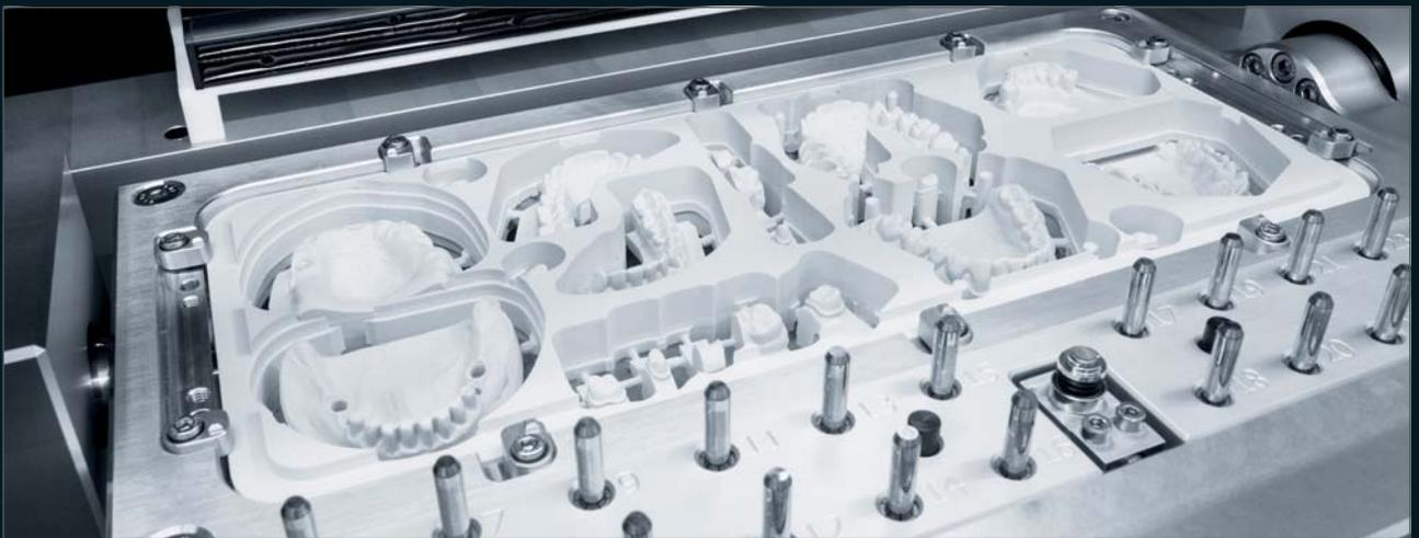
Utilizando el bloque extra grande Model Blank M4, se pueden producir en la fresadora M4 Wet Heavy Metal hasta 20 arcadas completas en un solo proceso de fresado.
